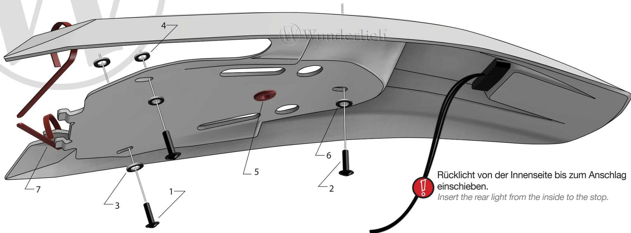
Rücklicht von der Innenseite bis zum Anschlag einschieben.
