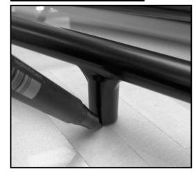
Die Auflageflächen der Reling großflächig mit TESA-Kreppband abkleben. Die Reling auf dem Topcase wie gewünscht positionieren.
