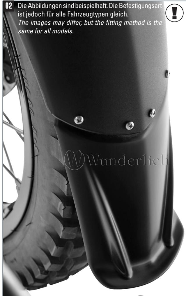
Befestigen Sie diesen abschließend mit den beiliegenden Schrauben (mit 2,5 mm-Bohrer durch Kotflügel und Extenda-Fender vorbohren) zusätzlich am Kotflügel: *Mark + drill four 2.5 mm (3/32") holes through both pieces. Attach the extender with the included self tapping screws.*
