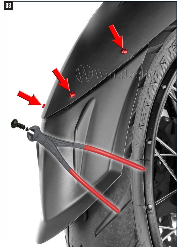
Falls die Schraubenspitze zu nah an den Reifen kommt, kann sie abgefeilt/ geschnitten werden. *In case that the screw tip comes too close to the tyre, the screw tip can be filed or cut off.*
