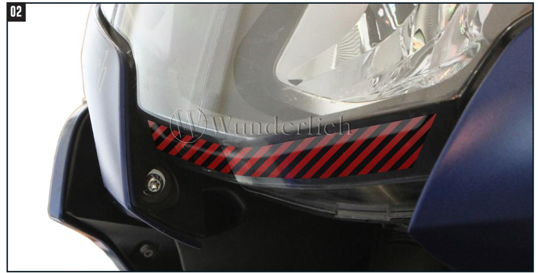
Schraffierte Fläche mit Lackschutzfolie bekleben!
