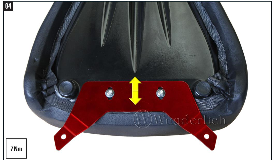
04 Halter so ausrichten, das sich Höcker oder Beifahrersitz spannungsfrei montieren lassen.
