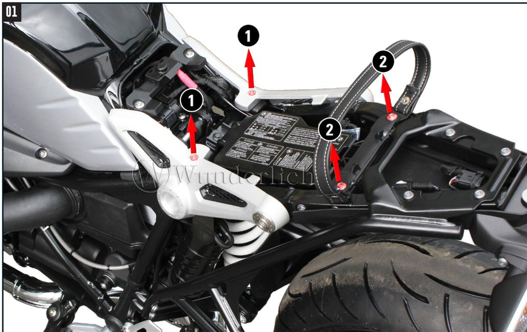
01 Vorab original Sitzbank demontieren. Schrauben 1 und 2 entfernen, Pos. 2 entfällt.
