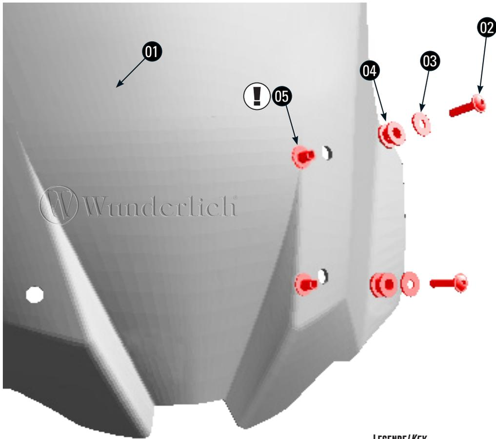
**!** Die Stufenhülsen (5) werden von innen in die Scheibengummis geschoben.
